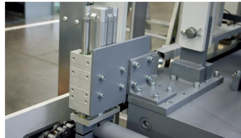
Abdrückeinrichtung zum Ablösen der Werkstücke, die nach dem Öffnen der Presse an der oberen Zulagefolie haften
