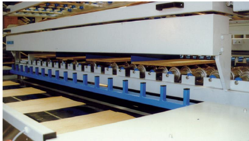
Scheibentransportstrecke mit automatisch positionierbaren Anschlägen
