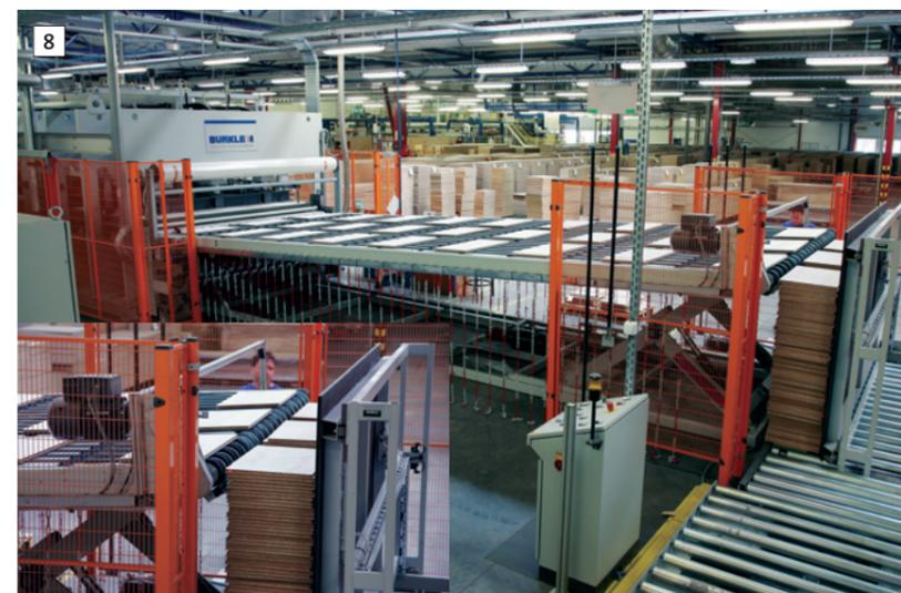
Stapelgerät mit Stapelwand
