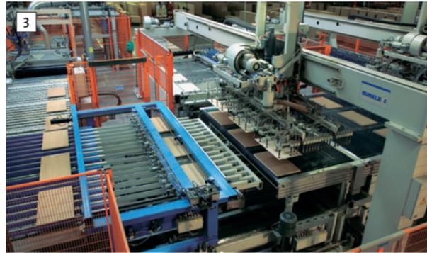
Klammerwagen für die Trägerplatten
