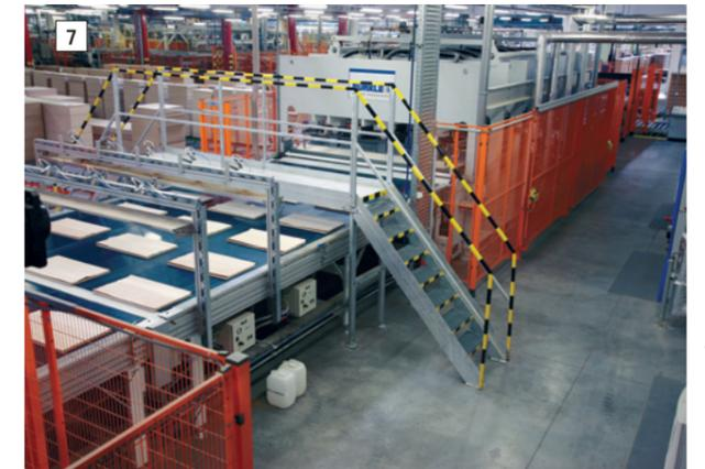
Kurztakt-Durchlaufpresse mit Beschickband und Befeuchtungseinrichtung
