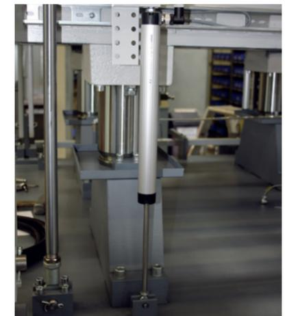
Fehlbelegungssicherung zur Vermeidung von Beschädigungen der beweglichen Heizplatte bei fehlerhafter Auslegung der Presse
