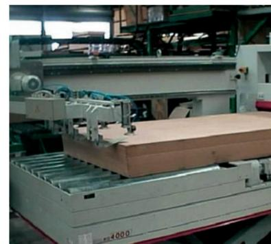
Einschubvorrichtung mit hydraulischem Scherenhubtisch zum taktweisen Beschicken der Anlage
