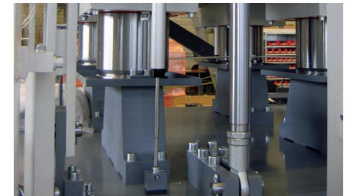
Fehlbelegungssicherung zur Vermeidung von Beschädigungen der beweglichen Heizplatte bei fehlerhafter Auslegung der Presse. Safety device to prevent faulty loading of the press and thus damage to the mobile heating platens.
