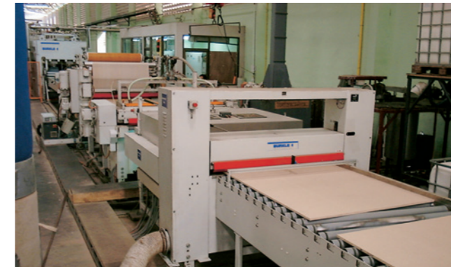
Bürstmaschine für optimale Entstaubung Brushing machine for an optimal dust removal
