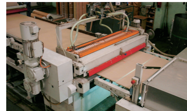
Leimauftragmaschine für gleichmäßigen Leimauftrag Glue spreading machine for uniform glue spread
