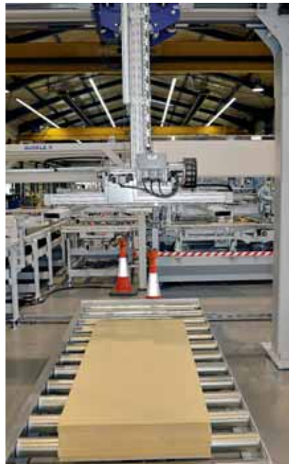
Oben: Die Teilezuführungen des Rahmenautomaten und der Einlagen. Links die Bürsten- und Leimauftragsaggregate, rechts der Kühligel, der am Ende der Fertigungslinie hinter der Presse platziert sein wird
