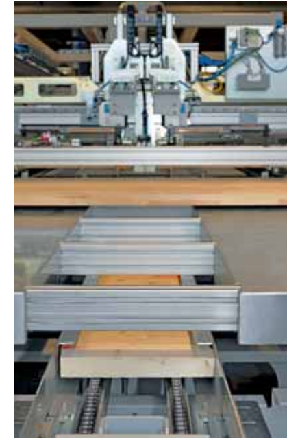
Hier werden die Schlossriegel in den Rahmenautomaten transportiert
