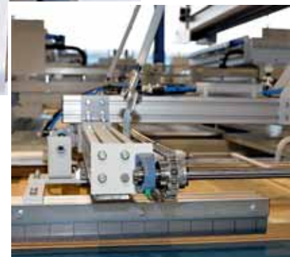
Oben: Die Teilezuführungen des Rahmenautomaten und der Einlagen. Links die Bürsten- und Leimauftragsaggregate, rechts der Kühligel, der am Ende der Fertigungslinie hinter der Presse platziert sein wird
